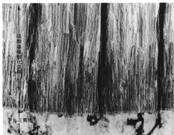
写真-2 二次電解着色皮膜の断面(100,000倍)
